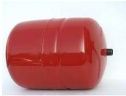
Расширительный бак и предохранительный клапан защищают систему от превышения давления. Объем жидкости увеличивается при поднятии температуры. Из-за этого в систему на энергии солнца входят расширительный бак, предохранительный клапан и манометр.
