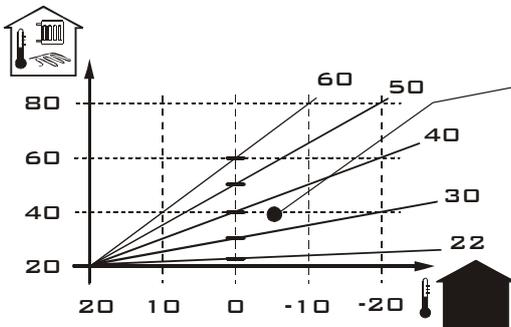
ОТОПИТЕЛЬНАЯ КРИВАЯ электродкотла, в которой по вертикали температура прямой воды и по горизонтали температура наружного воздуха
