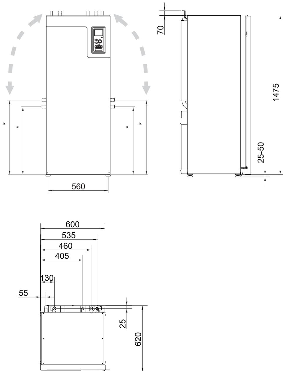
\* Поскольку колено трубы насоса для рассола состоит из гибкого шланга, трубы можно поднимать на несколько сантиметров при боковом соединении.
