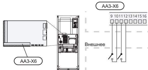
В вышеприведенном примере используются выходы AUX1 (X6:9-10) и AUX2 (X6:11-12) на клеммной колодке (AA3).
