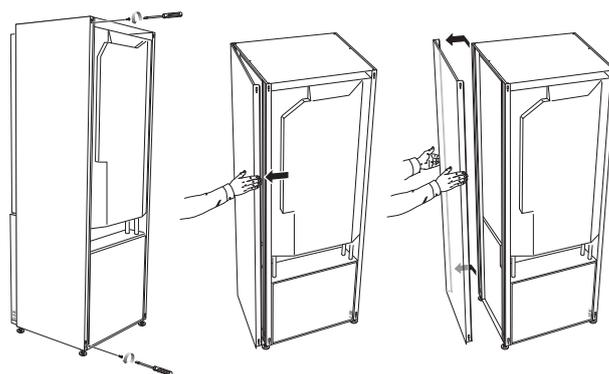
Боковые панели можно снять для облегчения установки.
