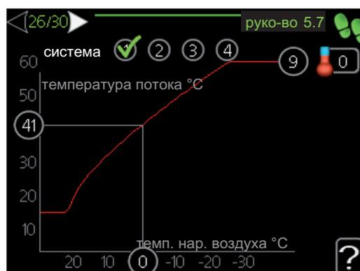
При базовой установке следует изменить уставки "кривая отопления" и "температура" (смещение кривой нагрева) системы климат-контроля.
