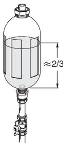
Если при работающем насосе для рассола (GP2) и открытом сосуде уровня (СМ2) закрыть клапан на главном подводящем трубопроводе, тогда повысится давление и жидкость будет вытекать из сосуда.
