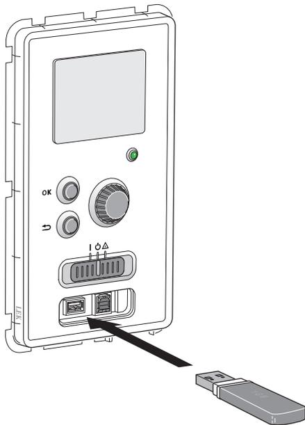
STAR оборудован разъемом USB в дисплее. Этот разъем USB можно использовать для подключения карты памяти USB для обновления программного обеспечения, сохранения зарегистрированных сведений и работы с уставками в STAR.
