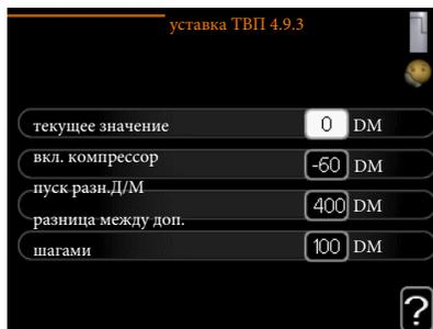
Температурно-временной показатель (ТВП) является измерением текущего требования по отоплению дома и определяет время соответствующего запуска/останова дополнительного отопления компрессором.
