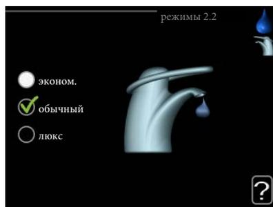
Выбранные режимы отличаются температурой горячей водопроводной воды. Более высокая температура означает, что горячей воды хватит на более длительное время.
