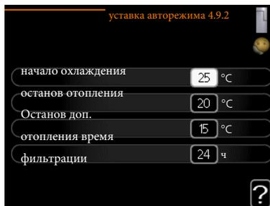
Когда рабочий режим установлен на «авто», тепловой насос выбирает время начала и остановки дополнительного отопления и определяет необходимость отопления в зависимости от среднегодовой атмосферной температуры. При наличии дополнительного оборудования для охлаждения или встроенной функции охлаждения теплового насоса можно также выбрать начальную температуру охлаждения.
