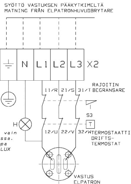
Merkkivalo vain LUX malleissa. Signallampa endast på LUX modeller.
