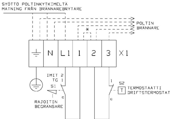
\* Huom! Polttimen 3-johdin järjestelmässä lisää lenkki 1-2, jännite polttimelle 3:sta.
